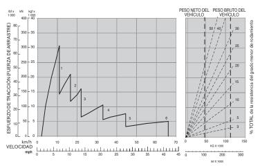
Instrucciones: Localize la intersección del peso del vehiculo cruzada con la línea de porcentage de resistencia para determinar la máxima marcha conseguida, y luego lea abajo la velocidad del vehículo.
